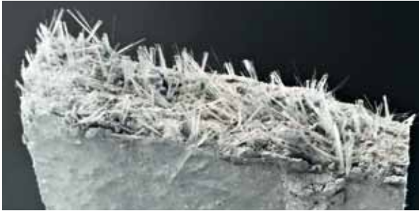
Faserbewehrung im Glasfaserbeton
