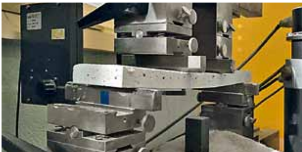
Biegeprüfung von Glasfaserbeton nach EN 1170-5
