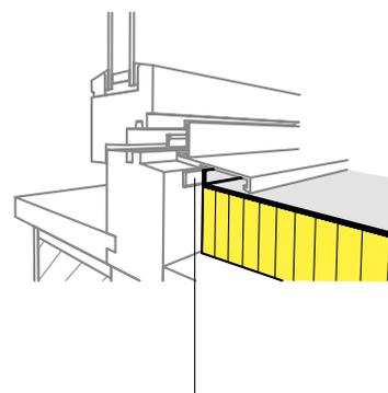
Stahlton-Fugendichtband BG 1 oder
