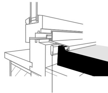
**Stahlton-Fugendichtband BG 1 oder
