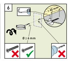
Fremdmontagen können mit Holz- oder Blechschrauben ohne Schaft Ø $\geq$ 6 mm direkt in die Montagestange erfolgen (Verankerungslänge  $\geq$  60 mm). Putz-durchdringung dichten (z.B. Stahlton-Klebdichtstoff).
