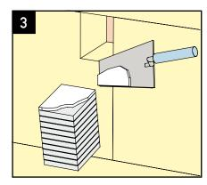
Klebemörtel (z.B. Kleber des Aussendämmsystems) vollflächig auf Rückseite der Montagestange auftragen.
