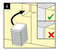
Montagestange auf tragenden Untergrund verkleben (Haftzugfestigkeit  $\geq 0.25\ N/mm^2)$  und dämmplattenbündig anpressen.
