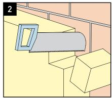
Montagestange mit Dämmung versetzen bzw. Aussparung in Dämmung ausschneiden.
