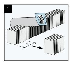
Die Montagestange auf die gewünschte Elementdicke D (Dämmstärke) zuschneiden (alle 10 mm möglich)
