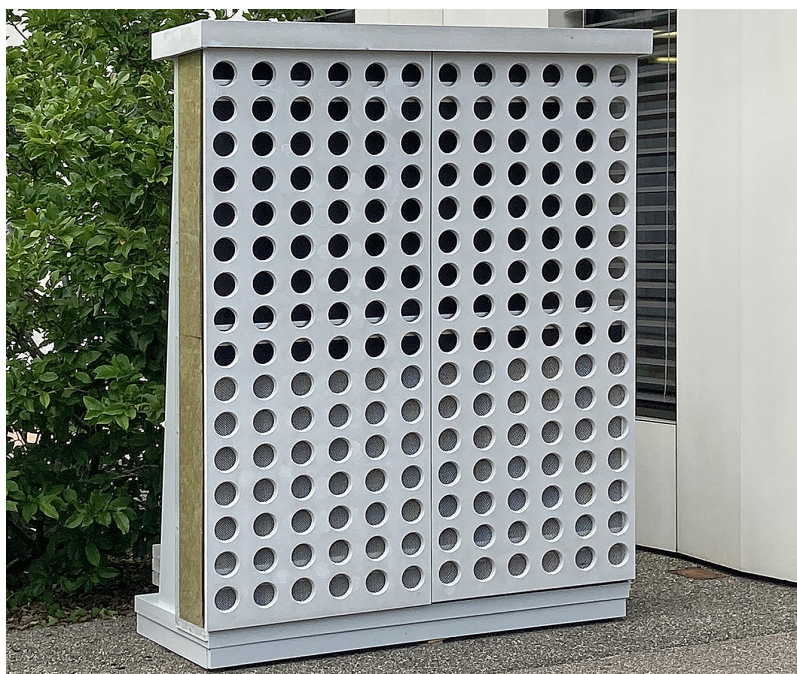
Mockup éléments acoustiques Ecomur flexPhon , perforé
