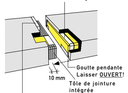
Pour joints droits ajouter év. masse pour joints et étanchéités Stahlton, pour joints à l'onglet toujours avec masse pour joints et étanchéités Stahlton
