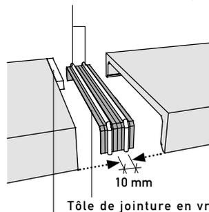
Pour joints droits ajouter év. masse pour joints et étanchéités Stahlton, pour joints à l'onglet toujours avec masse pour joints et étanchéités Stahlton
