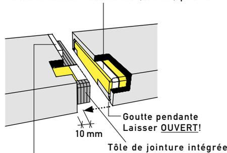
Pour joints droits ajouter év. masse pour joints et étanchéités Stahlton, pour joints à l'onglet toujours avec masse pour joints et étanchéités Stahlton
