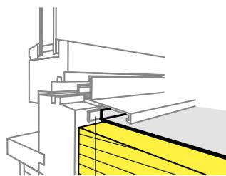
Bande d'étanchéité Stahlton BG 1 ou cordon ronde avec masse pour joints et étanchéités Stahlton
