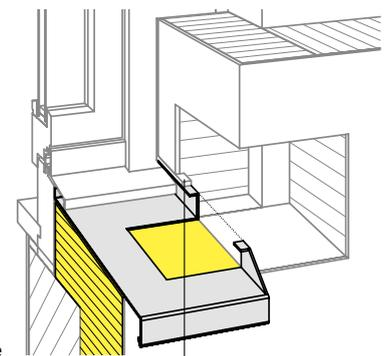
Bande d'étanchéité Stahlton BG 1 et masse pour joints et étanchéités Stahlton (aussi latéralement et face inférieure)
