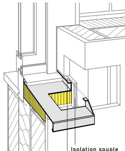
Bande d'étanchéité Stahlton BG 1 et masse pour joints et étanchéités Stahlton (aussi latéralement et face inférieure)
