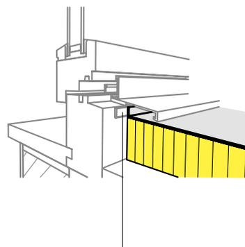
Bande d'étanchéité Stahlton BG 1 ou cordon ronde avec masse pour joints et étanchéités Stahlton
