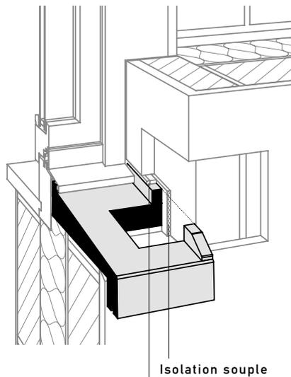
Bande d'étanchéité Stahlton BG 1 et masse pour joints et étanchéités Stahlton (aussi latéralement et face inférieure)
