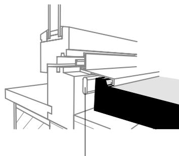
Bande d'étanchéité Stahlton BG 1 ou cordon ronde avec masse pour joints et étanchéités Stahlton
