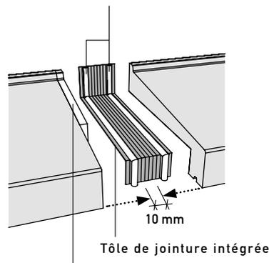
Pour joints droits et à l'onglet, toujours remplir les rainures avec masse pour joints et étanchéités Stahlton
