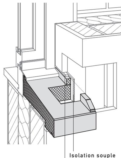
Bande d'étanchéité Stahlton BG 1 et
