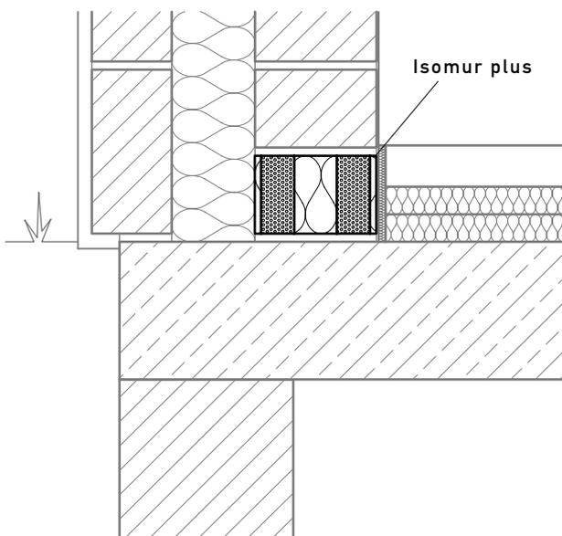
Wärmedämmelement unter der Decke
